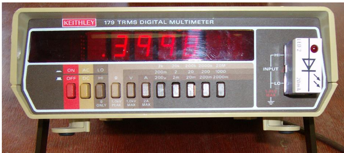
Abbildung 11: Umkehrung der Lichtemission der LED: Ein hochohmiges Voltmeter zeigt die von einer beleuchteten LED am Voltmeter durch Ladungsansammlung erzeugte Spannung in Volt an.
