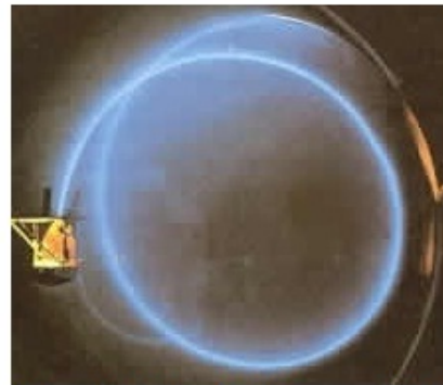
Schraubenbahn im Fadenstrahlrohr
