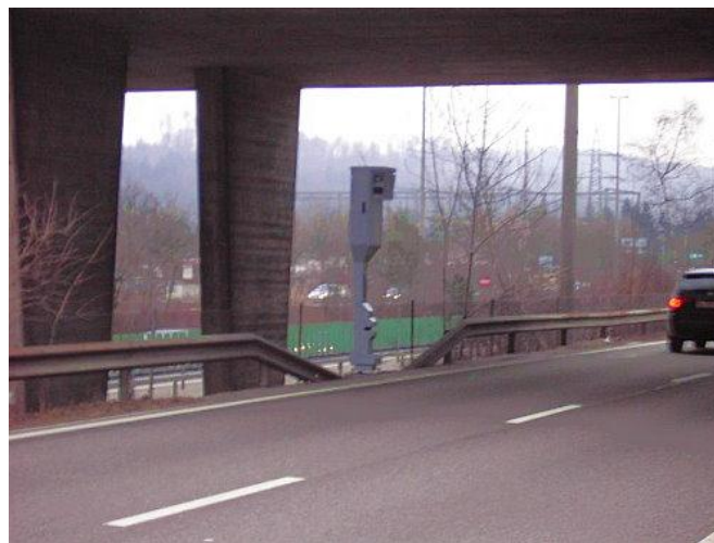
Die Videokamera unter der Brücke hat zu zwei Zeiten die Position der Hinterräder des Autos bestimmt.
