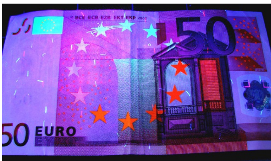
Abbildung 9: Einstiegsversuch zur Fluoreszenz: Geldschein im UV-Licht einer Hg-Lampe mit UV-Filter.
