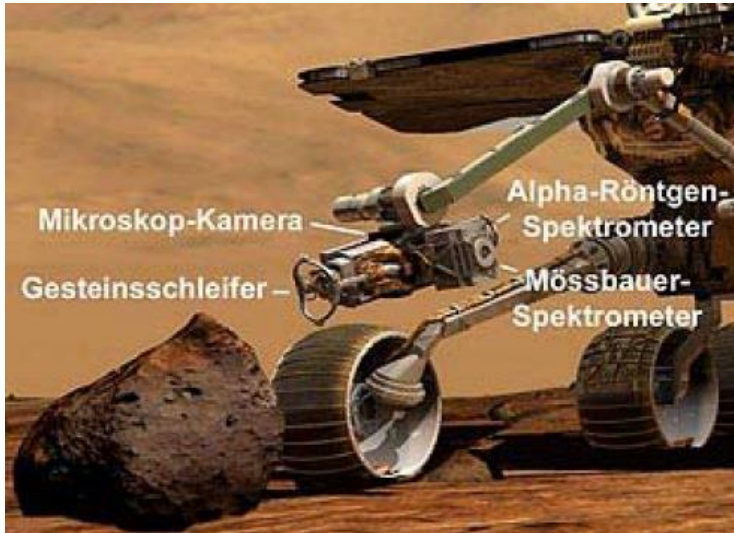
Mars Pathfinder: Bestimmung chemischer Elemente mit Röntgenstrahlung
