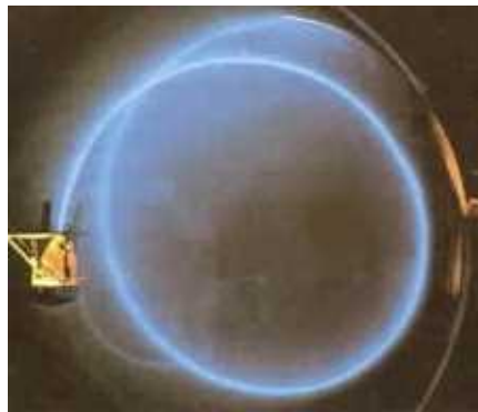
Schraubenbahn im Fadenstrahlrohr
