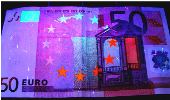
Fluoreszenz: Geldschein mit UV bestrahlt.
