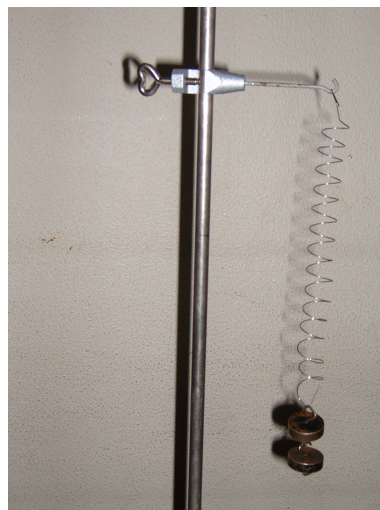
Abbildung 9: Beim eigenhändigen Wickeln einer Schraubenfeder entwickeln die SuS Handlungskompetenzen und entdecken die eigenartigen Eigenschaften von Federstahldraht.
