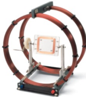
Abbildung 3: Ein Generator ohne Eisenkern erzeugt sehr deutlich eine Spannung mit sinusförmigem Zeitverlauf. Dieser ist leicht mit einem Oszilloskop darstellbar.
