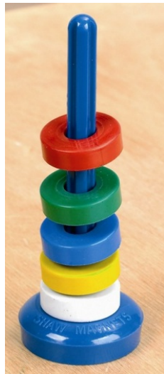
Abbildung 3: Das magnetische Schweben und das magnetische Kraftgesetz können die SuS werden bereits anhand von Kinderspielzeug entdecken.
