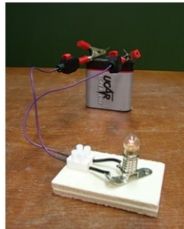
Abbildung 9: Die Schülerinnen und Schüler stellen mit selbstständig geplanten Versuchen fest, dass eine Lampe umso heller leuchtet, je größer die Spannungsangabe auf der elektrischen Quelle ist.
